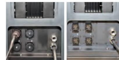
Bis zu 6 Anschlüsse für PT 100 oder Ni 120 Temperaturfühler
