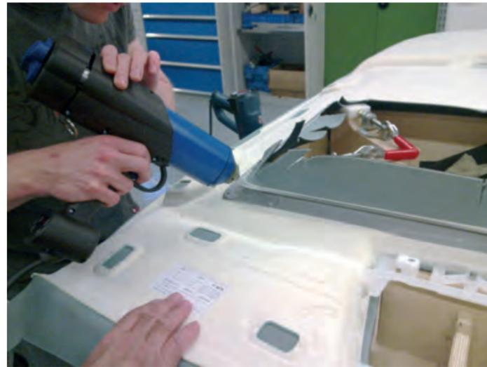
Der Klebstoff kann auch im festen Zustand als Folie oder Pulver zwischen die Fügeteile gebracht und anschließend durch Erwärmung verflüssigt werden. Nach der Benetzung muss der Klebstoff fest werden. Er verfestigt aufgrund eines physikalischen Abbindevorgangs. Durch Wärmeabfuhr geht er vom flüssigen in den festen Zustand über. Zunächst erhöht sich die Viskosität des Klebstoffes, um dann immer mehr an Festigkeit zu gewinnen.
