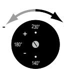
Nastavte teplotu dodaným šroubovákem (9) regulátorem teploty (3) na požadovanou hodnotu.
