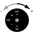
Réglez la température à la valeur souhaitée en ajustant la vis de réglage (3) à l'aide du tournevis fourni (9).
