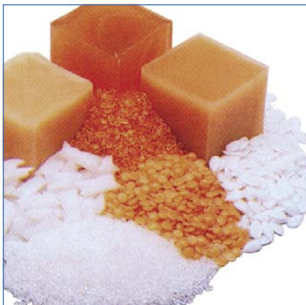
Alle relevanten Schmelzklebstofftypen EVA, PA, PO und thermoplastischer Kautschuk werden problemlos verarbeitet.
