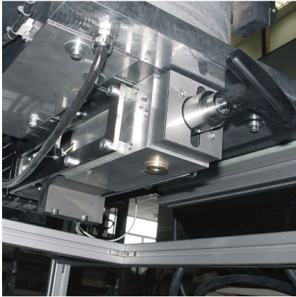
Bajonettfilter mit Pumpeneinheit und Schnellwechselfunktion
