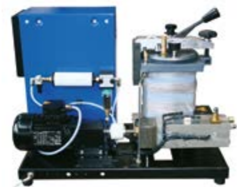
Konstrukce nenáročná na údržbu s dobrou přístupností k čerpadlu, pohonu, filtru a obtokovému ventilu
