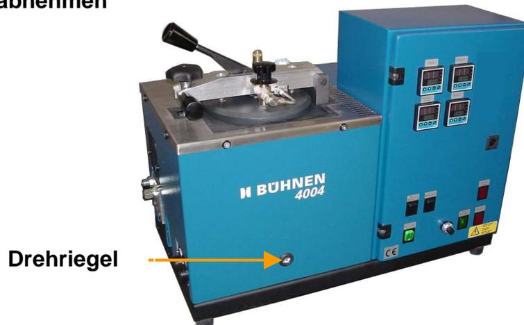
Die Abdeckhaube ist mit 2 Drehriegeln an dem Grundrahmen befestigt, nach dem Lösen dieser Drehriegel ist die Abdeckhaube nach oben abnehmbar.
