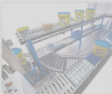
triebenen Leichtförderelemente flexibel kombinieren und an individuelle Einsatzfälle anpassen. Angeboten werden Rollenförderer, Rollenfördererkurven, Gurt- und Senkrechtförderer, Querverschiebewagen, Hub-Eckumsetzer mit 90°-Winkel und Pop-up-Hubausschleuser mit 30°- und 45°-Winkel. Die exakt aufeinander abge-
