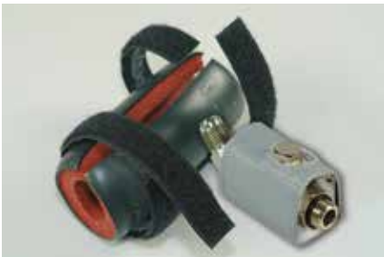
Szigetelő mandzsetta A tömlőarmatúra és a felhordófej (átfolyószűrő használata esetén), vagy a tankberendezés közötti hőhíd elkerülésére szigetelő mandzsettát használunk.
