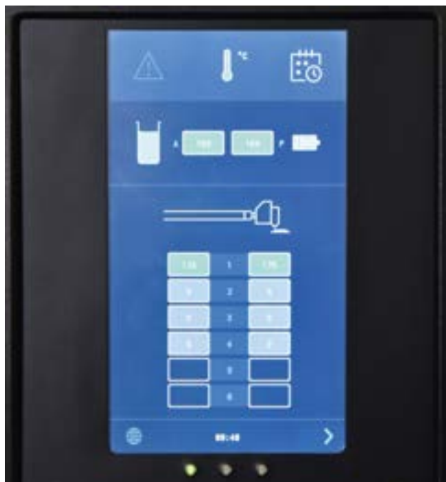
Könnyen programozható kezelő felület, 7"-os érintő képernyővel
